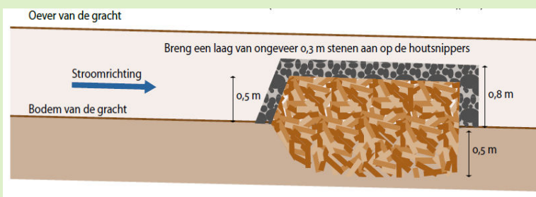
Figuur 3: Conceptueel schema van een bioreactor: de bodem van de gracht wordt 0,5 m uitgediept, een 1 m dikke laag houtsnipper wordt aangebracht, en het geheel wordt afgedekt met stenen om de houtsnipper op hun plaats te houden.
