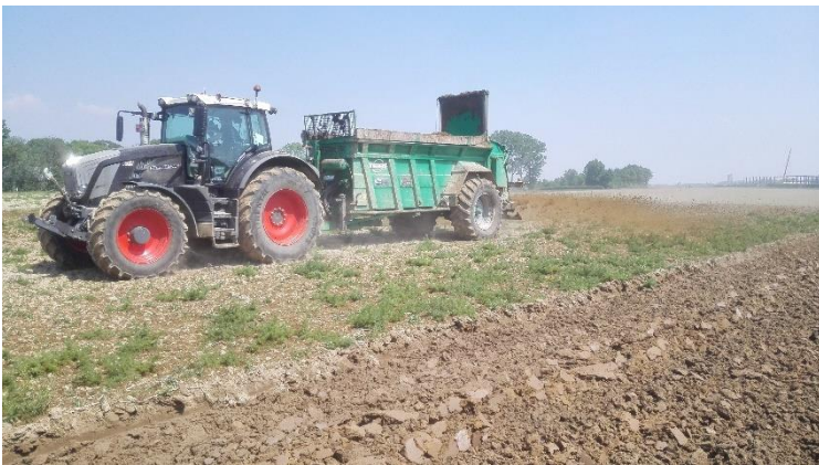
Figuur 7 Spreiden van dikke fractie runderdrijfmest met een stalmestwagen
