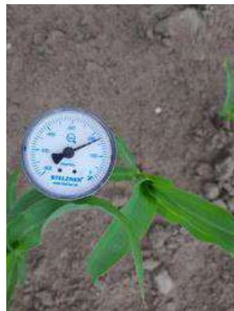
Tensiometer voor het meten van de zuigspanning van de bodem. Foto: PVL
