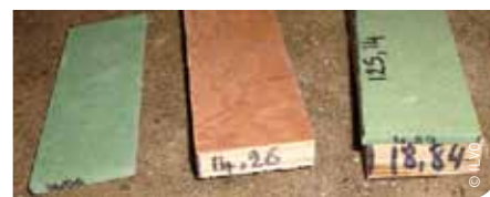
Plankjes met verschillende dikte om de exacte afstelling te garanderen.
