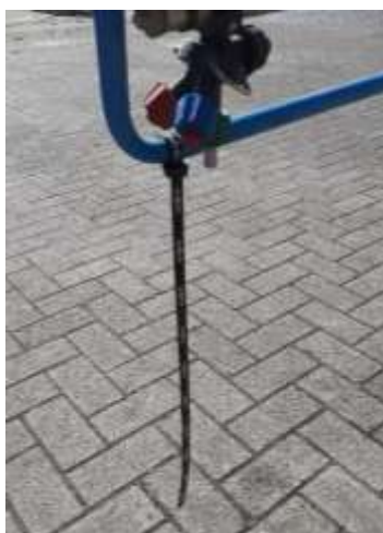
Figuur 11: een lange tiwrap kan prima dienst doen als spuihoogtemeter. Zo kan er vanuit de cabine makkelijk gecontroleerd worden of de boomhoogte goed staat ingesteld
