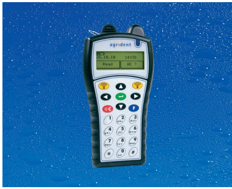
Figuur 15: Elektronisch oormerk en de draagbare scanner voor het inlezen van de dieren
